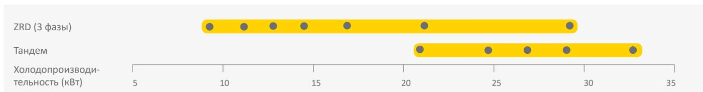
Условия по EN12900: кипение 5 °C, конденсация 50 °C, перегрев 10 K, переохлаждение 0 K
