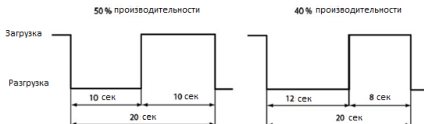
Рис. 22: Сигнал контроллера, активирующий разгрузку
