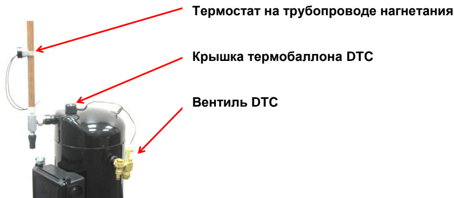
Рис. 15: Компрессор ZF*K5E-TFD, впрыск жидкости через DTC и термостат на трубопроводе нагнетания
