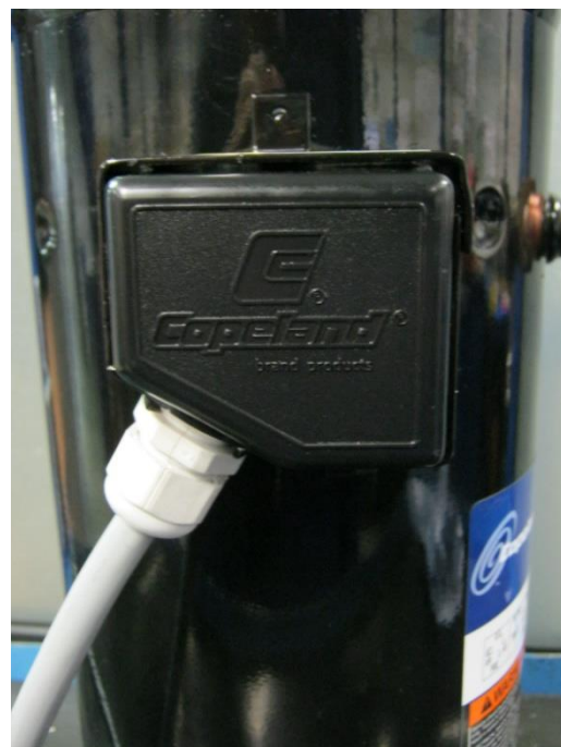
Рис. 12: Правильное подключение клеммной коробки IP21 с использованием кабельной муфты, ZH04K1P
